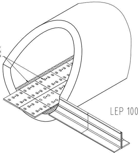
Betonrohr mit Klimasohlplatte
